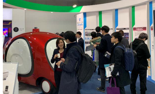
「Postee」は、完全自動運転による無人配送・配達を想定したラストマイルデリバリーのためのコンセプト車両で前後左右全面に荷室扉を、側面には投函口も配し、車内は全室荷室の構造となっています。
