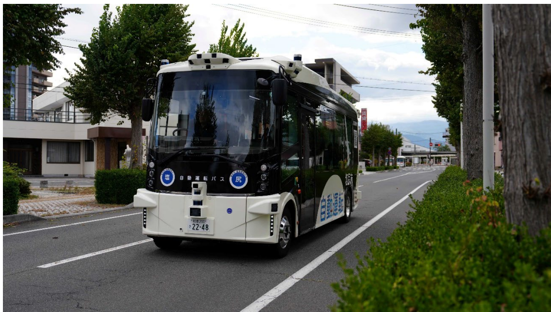
レベル4認可の取得に至った長野県塩尻市の走行環境と自動運転バス車両「Minibus」※1
